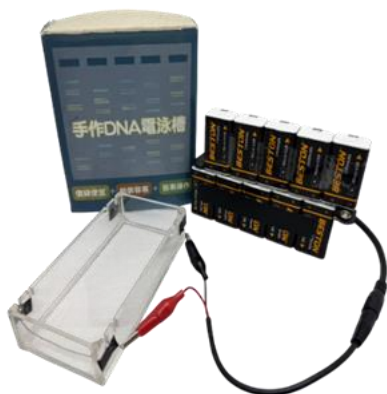
圖一：DNA 水平電泳槽系統模組。
